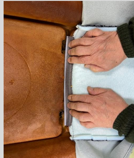
新しいトリムカバーを被せ外した時と逆の手順でヘッドレスト下部の吊り込み、センター部の吊り込みの順に留めていきます。
