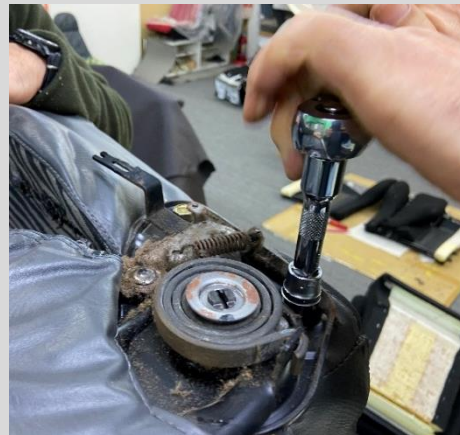
シート座と背を止めているボルトを外す。
