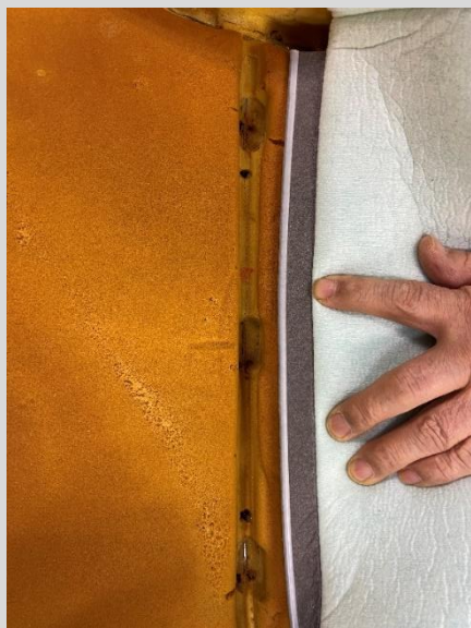
最初に座面部センターの吊りこみ部から留めていきます。
