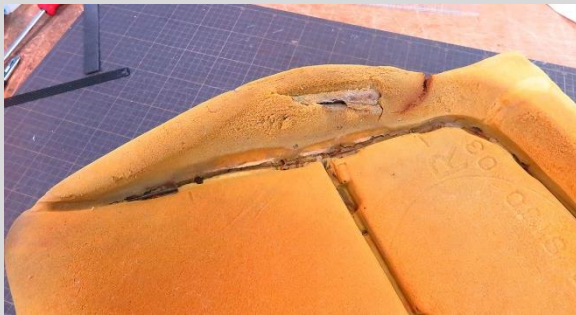
ウレタンがちぎれフレームが露出している場合
