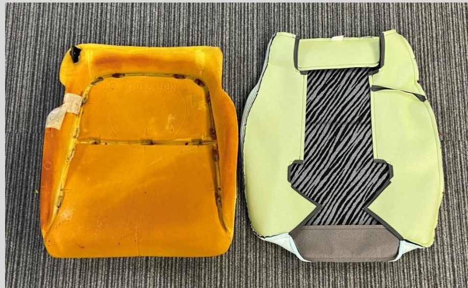
新しいトリムカバーを付けていきます。
