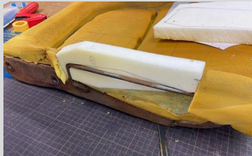
正常な状態のガバリ(型紙)を取った後に不良箇所をカットし、シートと同じ密度のウレタンブロックで改修。
