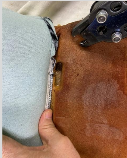
新しいトリムカバーを被せ外した時と逆の手順でヘッドレスト下部の吊り込み、センター部の吊り込みの順に留めていきます。
