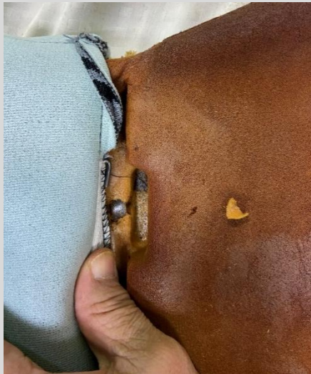
新しいトリムカバーを被せ外した時と逆の手順でヘッドレスト下部の吊り込み、センター部の吊り込みの順に留めていきます。
