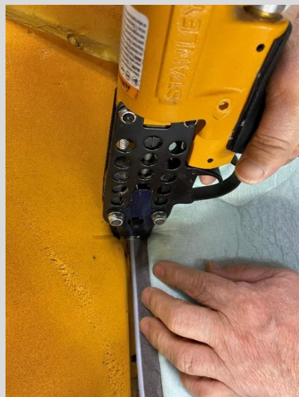
最初に座面部センターの吊りこみ部から留めていきます。
