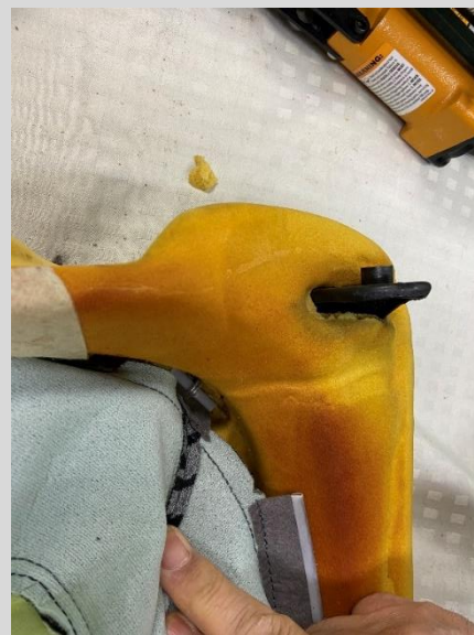
次にサイドボルスター部と座面の吊りこみ部を全周留めます。
