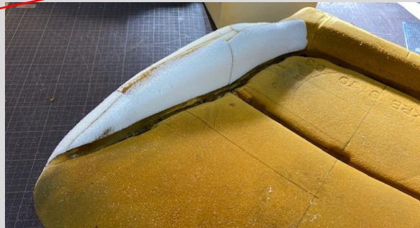
ガバリに合わせて成型していきます。
