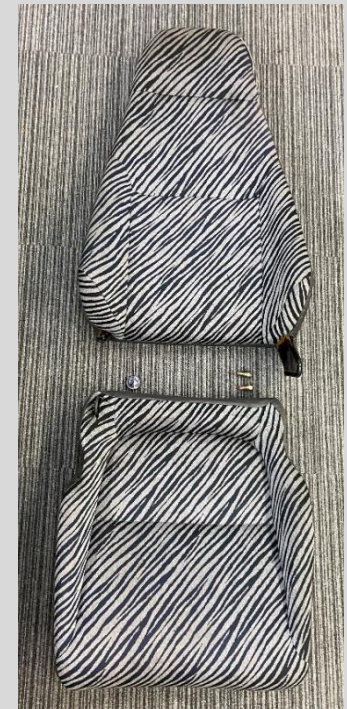
シートバック(背)とクッション(座)が外せます。助手席も同様です。
