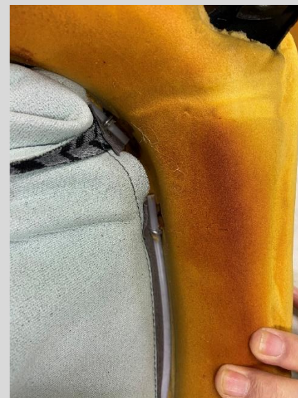
次にサイドボルスター部と座面の吊りこみ部を全周留めます。
