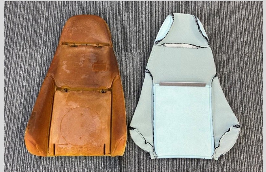
新しいトリムカバーを付けていきます。
